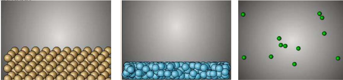
Figura 1. Representación esquemática de estados sólido, líquido y gas.
